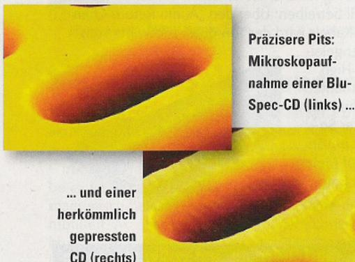
Präzisere Pits: Mikroskopaufnahme einer Blu-Spec-CD (links) ...
